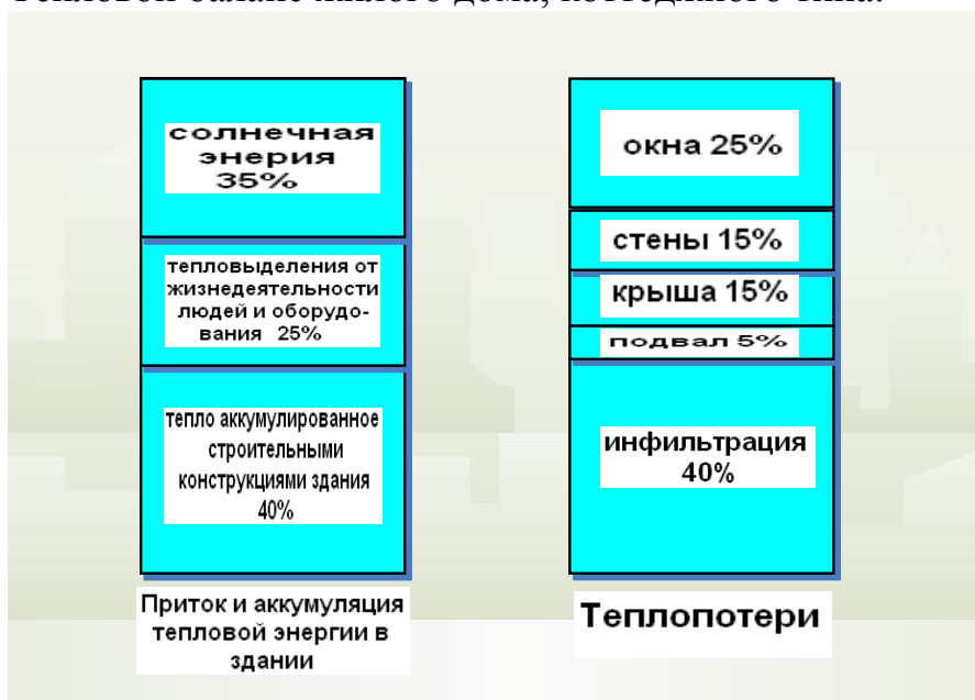
Рис.1. Тепловой баланс жилого дома, коттеджного типа.
